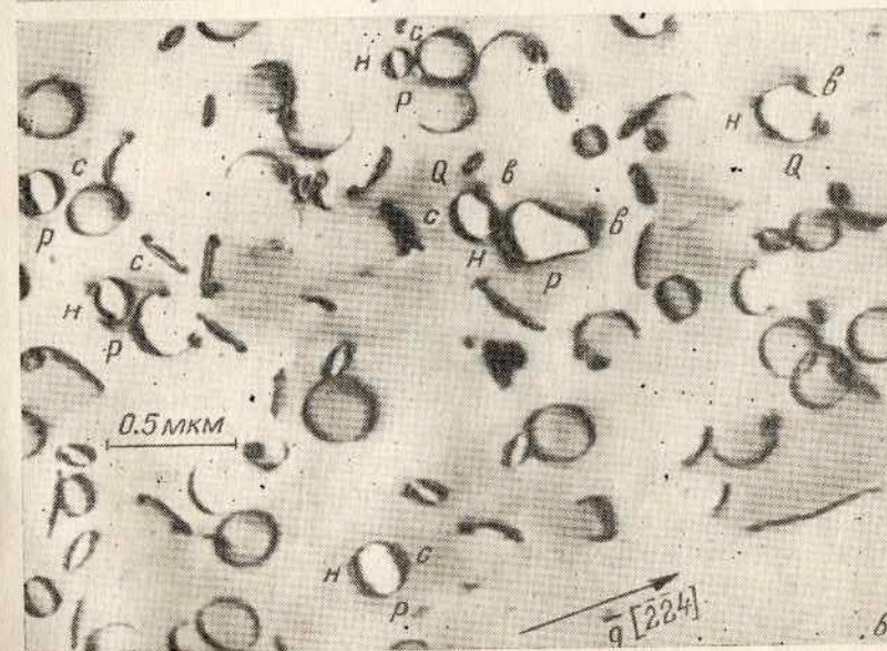
Рис. 2. Светлополюсное электрономикроскопическое изображение наклонных петель в германии, легированном мышьяком.
